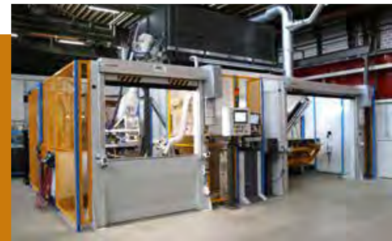
Auf einer neuen Schweißanlage im Werk Iserlohn werden neue Varianten des VW Unterfahrschutzes gefertigt. Jeweils eine bzw. zwei zusätzliche Bodenplatten verstärken den Unterfahrschutz für den Einsatz schwererer leistungsfähigerer Batterien für mehr Reichweite.
