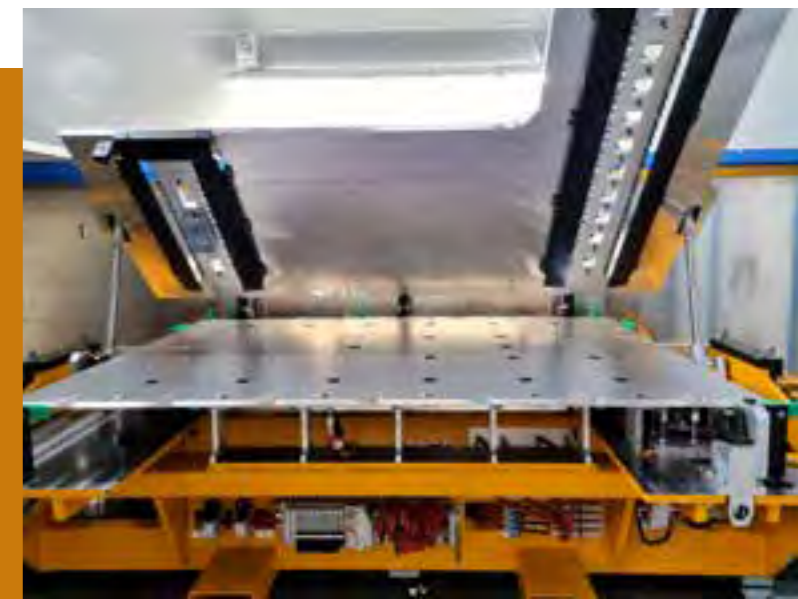
Unterfahrschutz in der Schweißvorrichtung.
